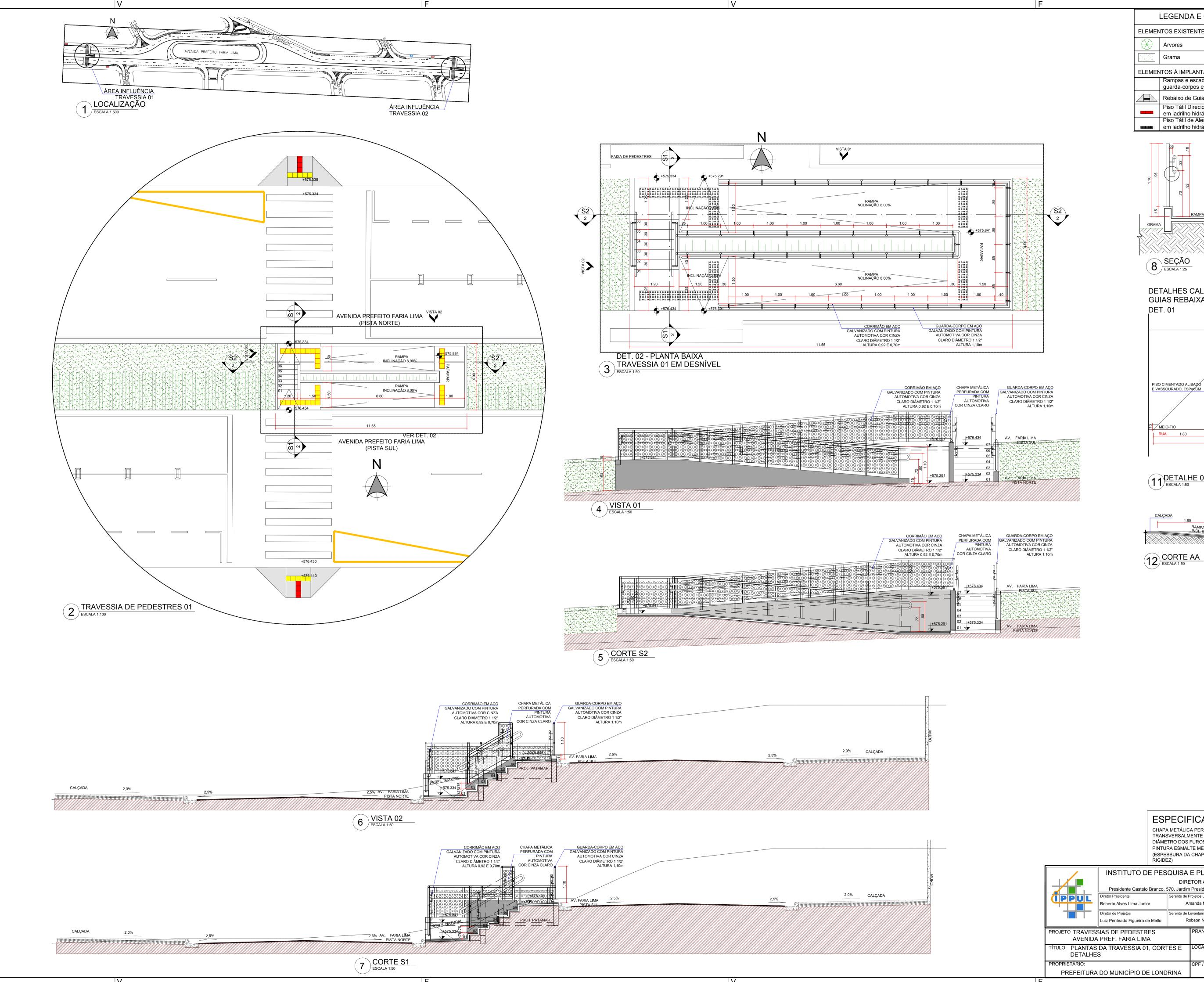
LEGENDA E QUANTITATIVO TRAVESSIA 01 **ELEMENTOS EXISTENTES** ☑ Poste Rede Elétrica Piso Tátil Direcional e Alerta em ladrilho hidráulico QUANTIDADE ELEMENTOS À IMPLANTAR Rampas e escada em concreto com 42,86 m² guarda-corpos e corrimãos Rebaixo de Guia 02 Piso Tátil Direcional 08 un. em ladrilho hidráulico Piso Tátil de Alerta 40 un. em ladrilho hidráulico
